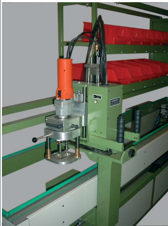
Tragzapfenbohrraggregat Drilling unit for carrying pivots Perceuse pour tourillons porteur
